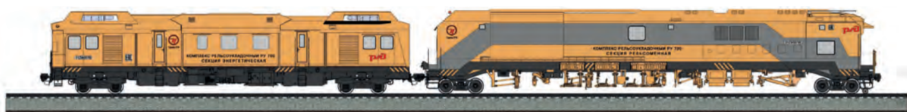
Рис. 7. Рельсоукладочный комплекс РУ-700
